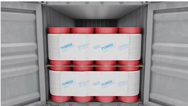
Cuando el contenedor llegue a destino, simplemente cortar el Ty-gard, quitar la carga y despegar el Ty-Gard2000 de las paredes del contenedor tirando hacia adelante. (se despegar con facilidad).
