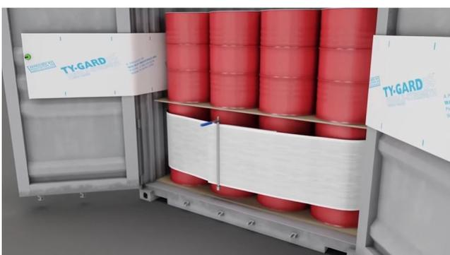
Insertar la herramienta Ty-Tool a través de las 2 bandas solapadas.
