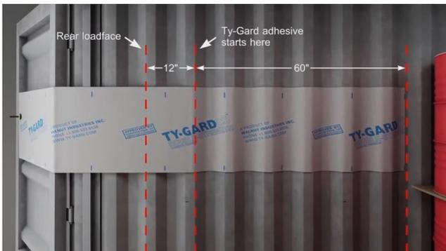
Sugerimos que la superficie de contacto del adhesivo empiece como mínimo 30 cm. antes que la parte final de la carga.
